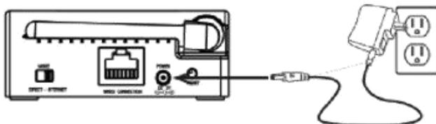
2. Подключите мост к Вашему роутеру с помощью кабеля Ethernet (в комплекте). Убедитесь, что коммутатор услуг показывает «INTERNET». Режим «DIRECT» только для технического обслуживания.
