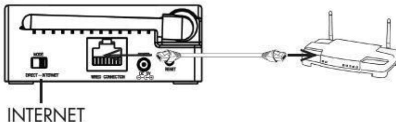
3. Подключите монитор к разъёму питания /сетевому разъёму моста. Используйте прочные направляющие для размещения монитора. При подключении к мосту идёт зарядка монитора. Для полной зарядки батареи требуется 5 часов.
